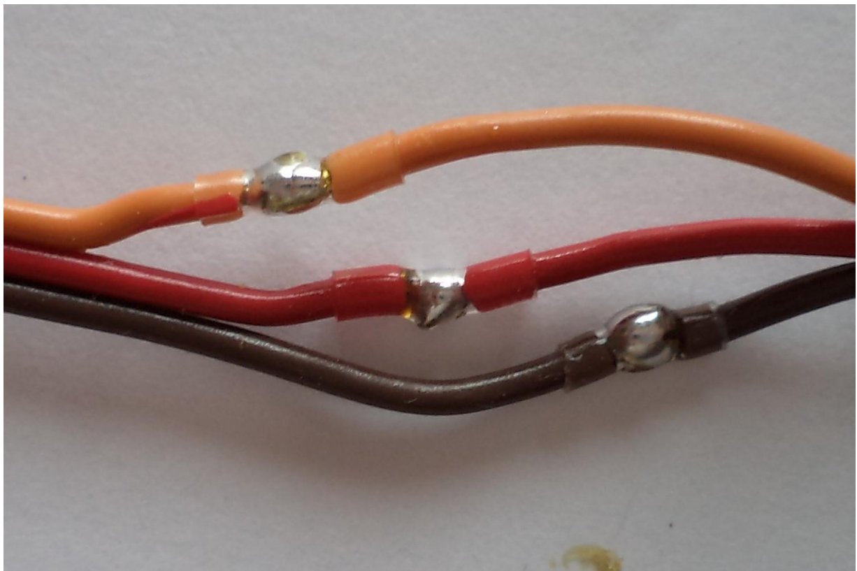
Kabelenden nur ca. 2mm abisolieren.
