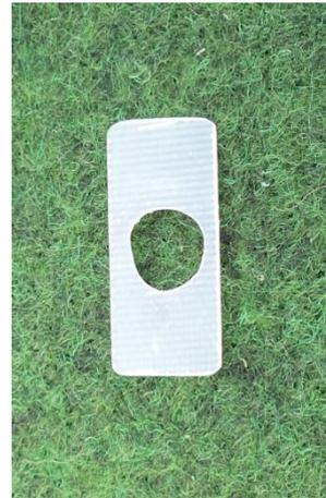
Abhilfe schafft ein kleines Stückchen eines möglichst elastischen Materials, wie Federblech oder GFK.
