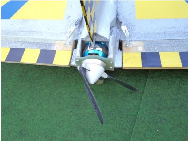
Legt sich ein Propellerblatt so an, wird die Fliehkraft das Blatt nicht nach außen drücken. Eine starke Unwucht wird die Folge sein.
